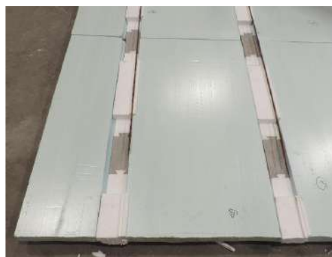
Fotografía 2. Sistema con elementos de apoyo de EPS y bloque de hormigón.
